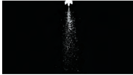
O desing da ponta permitiu padrão de pulverização de alta vazão evitando a formação de gotas com risco de deriva.
